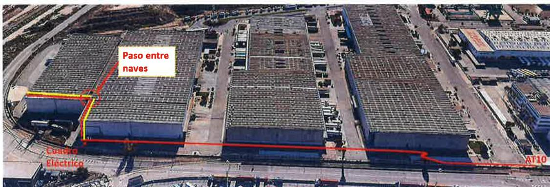
La parte de tendido que transcurre por fachada y azotea se deberá proteger con tubo metálico galvanizado.
